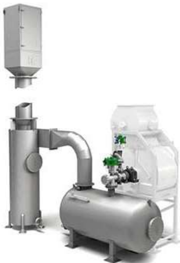
Рис. 4. Машина очистки овощей паром Orbit 80I
