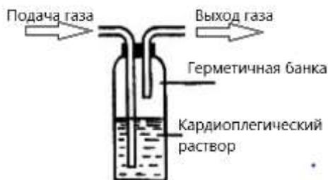
Рис. 3. Система увлажнения газовой смеси
