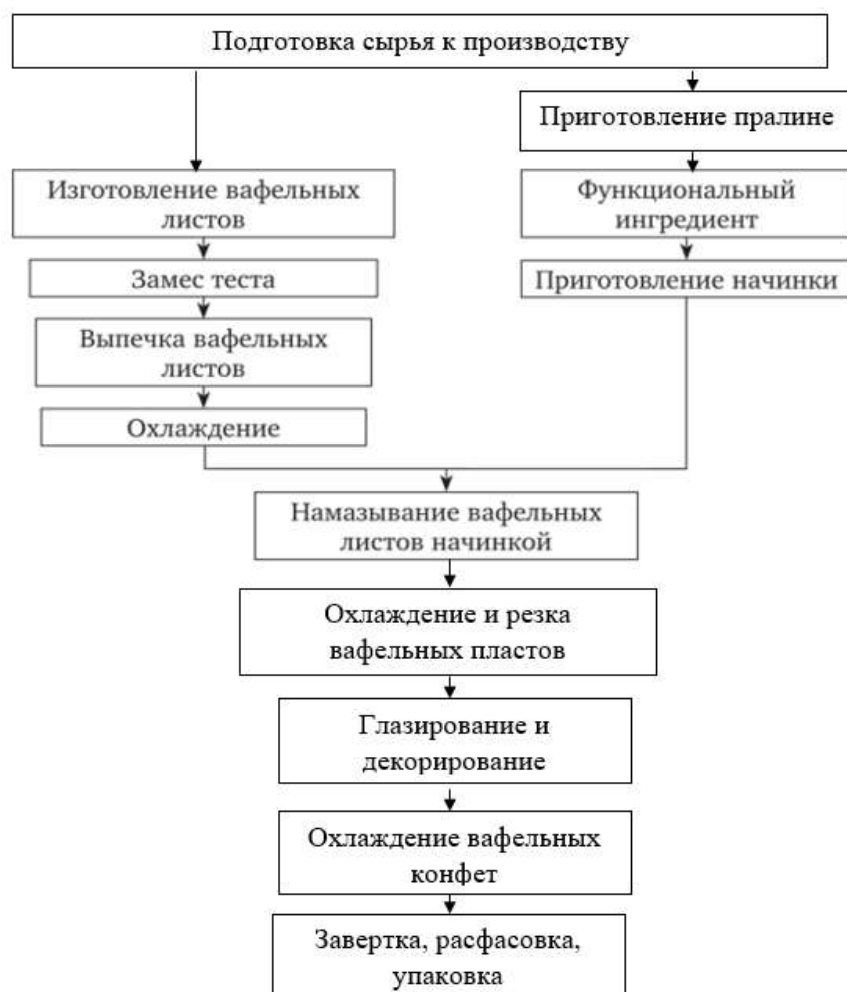
Рис. 3. Технологическая схема производства вафельных глазированных конфет
