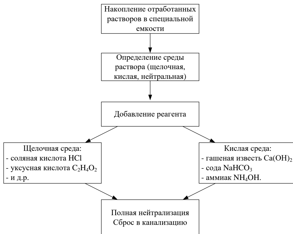
Рис. 1. Технология сброса в канализацию лаборатории растворов, требующих нейтрализации
