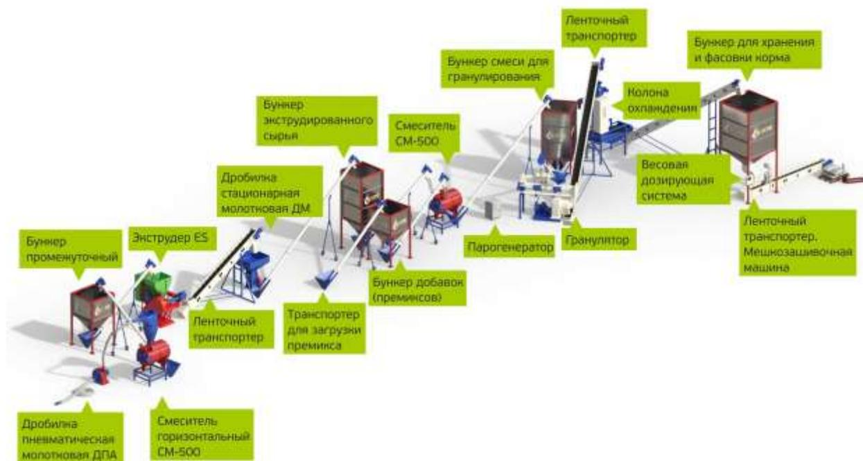
Рис. 1. Пример, устройства брикетирования корма
