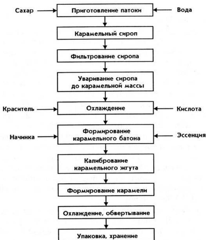
Рис. 1. Технологическая схема получения карамели
