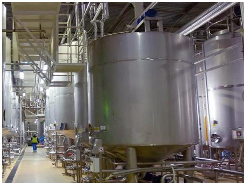
*Рис. 5. Аппарат для процесса дефекации*
