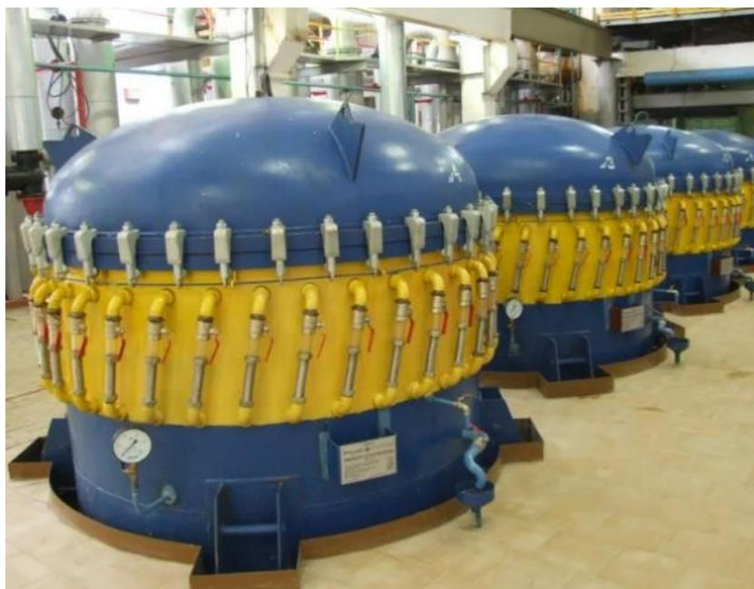
*Рис. 6. Аппарат для процесса сатурации*
