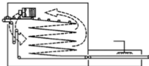
Рис. 3. Совместное использование криогенного и спирального замораживания
