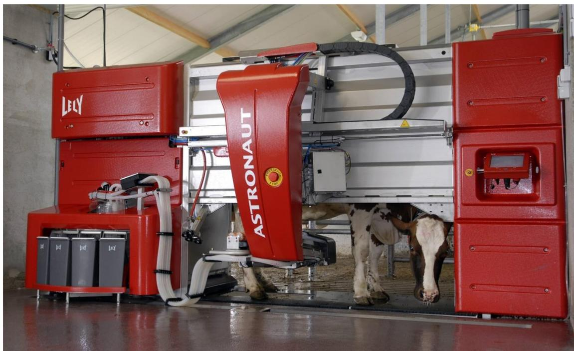
*Рис. 1. Аппарат роботизированного доения Lely марки Astronaut*
