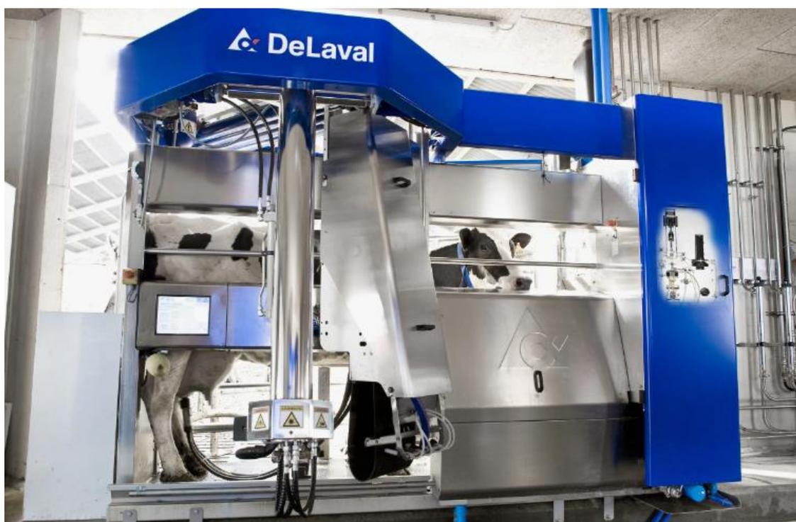
*Рис. 2. Аппарат роботизированного доения DeLaval марки VMS*
