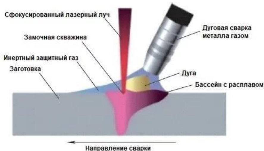
Рис. 1. Схема гибридной лазерной сварки
