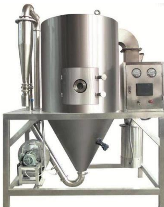
Рис. 1. Распылительная центробежная сушилка
